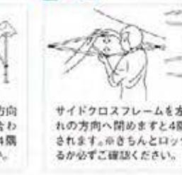
サイドクロスフレームを左回りそれぞれの方向へ閉めますと4脚がロックされます。きちんとロックされているか必ず確認ください。
